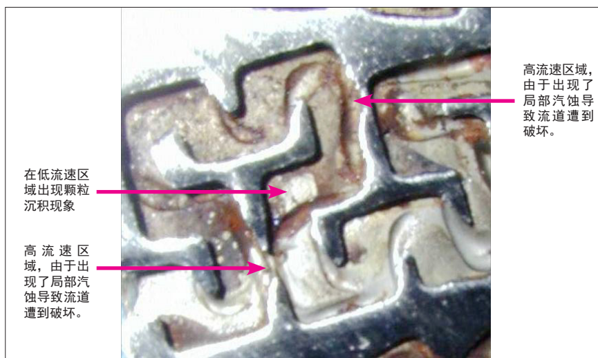
图6 遭到破坏的迷宫碟片
