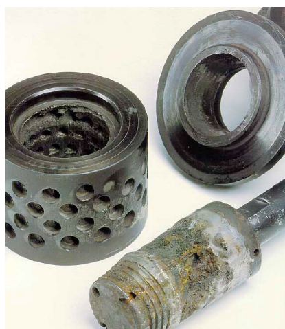
图1 由于汽蚀导致损坏的阀内件
